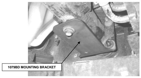
**STEP 2.** POSITION 1079BD LOWER MOUNTING BRACKET OVER THE STUDS, AND LOOSELY ATTACH THE BRACKET TO THE FRAME USING THE FACTORY NUTS AND BOLT AS SHOWN.
